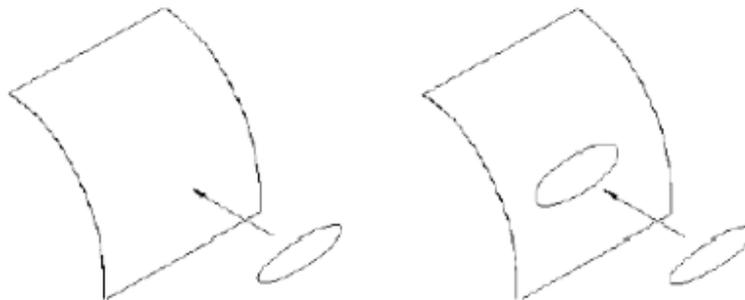
In der linken Grafik wurde die Kurve projiziert (Fläche und Projektionskurve sind zwei getrennte Objekte), in der rechten Grafik wurde sie aufgedruckt (Fläche und Projektionskurve sind ein Objekt)
