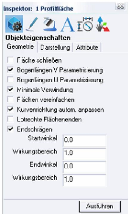
Dazu markieren Sie eine Profilfläche und blenden dann das Dialogfenster Inspektor entweder mit dem Befehl Inspektor im Menü Fenster oder über das Kontextmenü ein, das Sie mit der rechten Maustaste [Macintosh: rechte Maustaste, falls vorhanden, oder Strg-Taste] öffnen.
