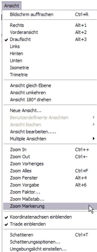
Sechs der vordefinierten Ansichten lassen einen Betrachter das Modell parallel zur Modellachse betrachten. Die anderen zwei erlauben eine isometrische oder trimetrische Sicht auf die Vorderseite des Modells.
