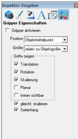
Sie können Oberflächen individuell bearbeiten, indem Sie das Deep Select-Werkzeug und den Gripper verwenden. Sie können sie verschieben, drehen und skalieren. Mithilfe der Options-/Strg-Taste können Sie zudem Mehrfachkopien entlang Oberflächen erstellen.
