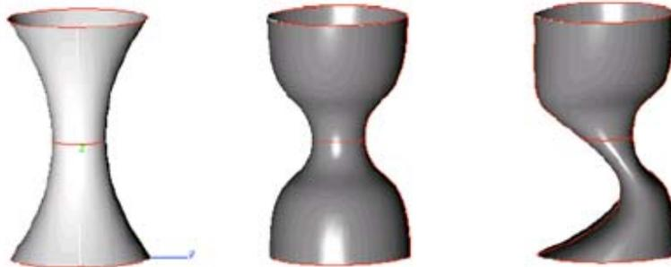
(a) Profilfläche (b) Profilfläche mit einer Führungskurve (c) Profilfläche mit zwei Führungskurven
